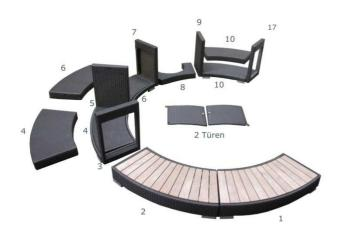
Beachten Sie bitte, dass die Beine 3 und 17 links und rechts neben dem Einstieg zu montieren sind. Achten Sie beim Befestigen auch darauf, dass sich die oberen Schraubenhülsen auf der Innenseite, abgewandt vom Einstieg, befinden. In der Vorderansicht sollen somit oben an den Beinen keine offenen Schraubenhülsen sichtbar sein. Sie haben jetzt zwei Möglichkeiten Beine Nr. 3 und 17 zu verschrauben.
