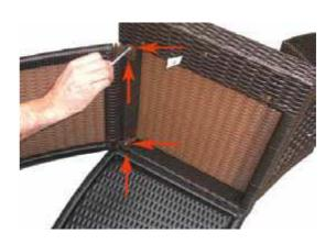
2. Ist dagegen eine erhöhte Flexibilität des Einstiegs gewünscht, so stecken Sie die Schrauben Nr. 1 umgekehrt, also vom Einstieg her, durch die Schraubenhülsen der Beine Nr. 3 und 17 und sichern sie mit den entsprechenden Muttern. Haben Sie alle Beine befestigt, so sollte sich ein Bild, wie in Abb. 5 zu sehen, ergeben.
